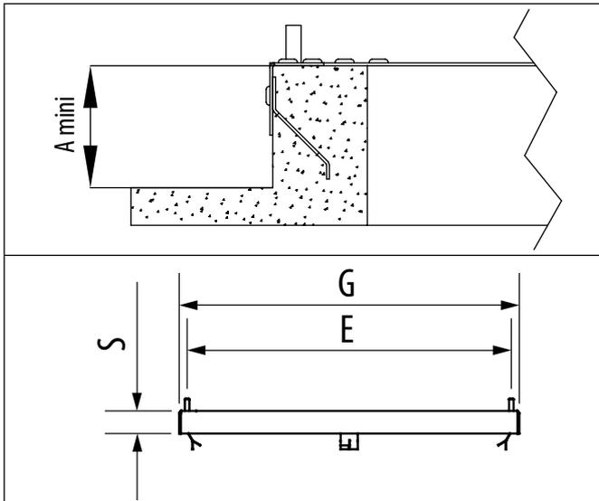
Sceller le cadre dans le support maçonné et s'assurer que les pattes de scellement soient bien noyées dans le béton.
