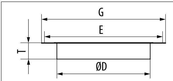
La plaque d'adaptation permet de raccorder la tourelle à un conduit circulaire. Il s'agit d'une pièce permettant le raccordement aéraulique, elle n'est pas prévue pour supporter le poids de la tourelle. Elle est incompatible avec l'utilisation du volet d'économie d'énergie AJCA et de la costière acoustique.
