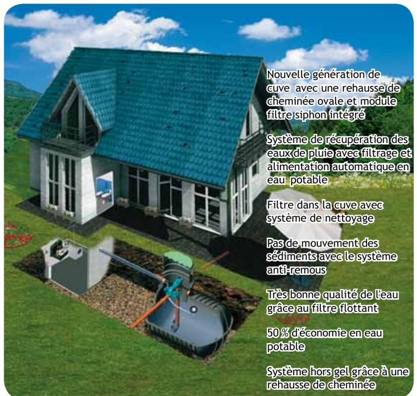
Nouvelle génération de cuve avec une rehausse de cheminée ovale et module filtre siphon intégré
