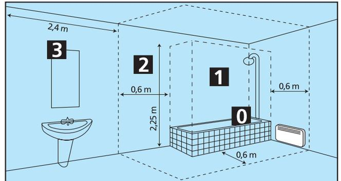
**Volume 3** : désigne l'espace situé jusqu'à 2,4 m du volume 2. Pour être installés dans ce volume, les chauffages électriques doivent être au minimum classe I (avec raccordement à la terre).
