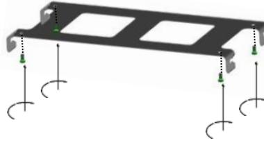
3. Positionner la VMC OZEO FLAT sur la platine et insérer latéralement les quatre vis-support dans les logements de la platine. Serrer les quatre vis-support.
