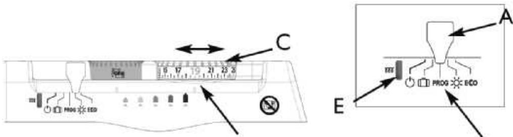
Si la température ambiante de la pièce est inférieure à celle désirée dans le mode choisi (température de Confort dans le mode Confort ☀ et température abaissée dans le mode **ECCO**), le voyant de chauffe E s'allume.
