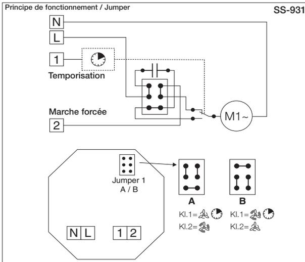
**Réglage interrupteur DIP**
