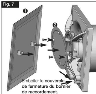
1. Emboîter le couvercle du bornier de raccordement 2 dans la rainure, appuyer sur le caisson et serrer
