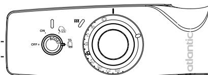
*Autre exemple : La molette D est positionnée sur 21° C. La température affichée sur votre thermomètre est de 18°C. La valeur d'étalement sera donc de -3°C (3 crans).*
