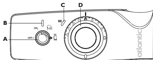
**A** Molette de sélection des modes et de Verrouillage des commandes.
