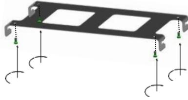
3. Positionner la VMC DECO FLAT DHU sur la platine et insérer latéralement les quatre vis-support dans les logements de la platine. Serrer les quatre vis-support.
