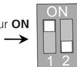
Mode manuel = commutateur **SW1** sur OFF pour désactiver le mode de débit constant. (Réglage d'usine).
