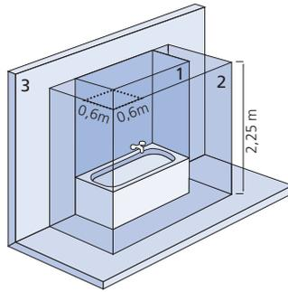
Le ventilateur doit se trouver hors du volume de sécurité de la salle de bain (volume 1).
