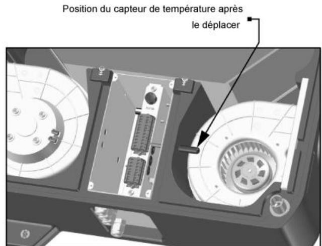
5. Retirez le capteur de température de la paroi du boîtier de commande et insérez-le dans le trou du côté opposé du boîtier de commande. Avant cela, percez dans la cloison en polypropylène expansé avec un outil pointu approprié à travers le trou du boîtier métallique du boîtier de commande.
