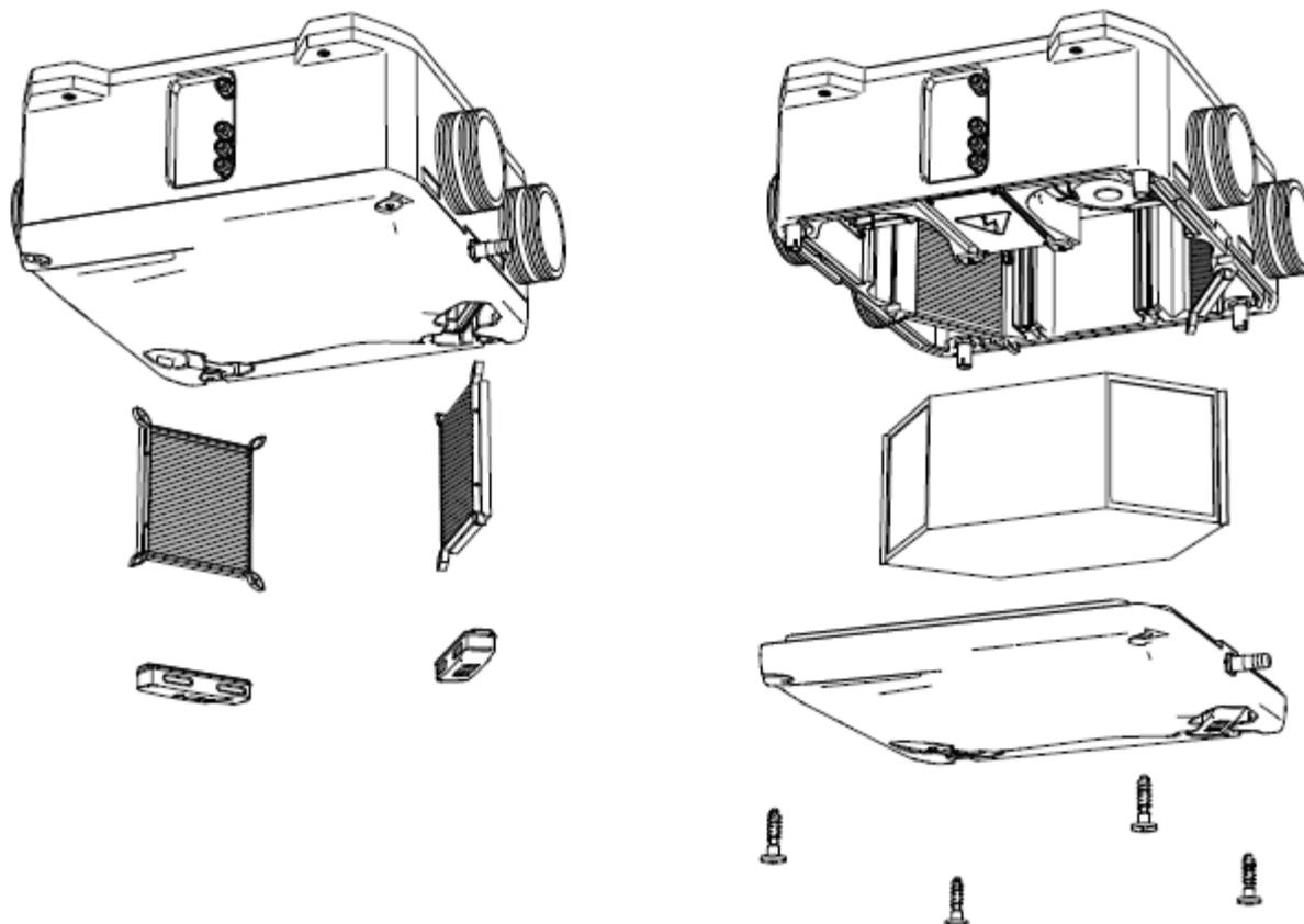
De la poussière peut s'accumuler sur l'échangeur thermique même en cas d'entretien régulier des filtres. Pour maintenir une efficacité élevée de récupération de chaleur, un nettoyage régulier est nécessaire.
