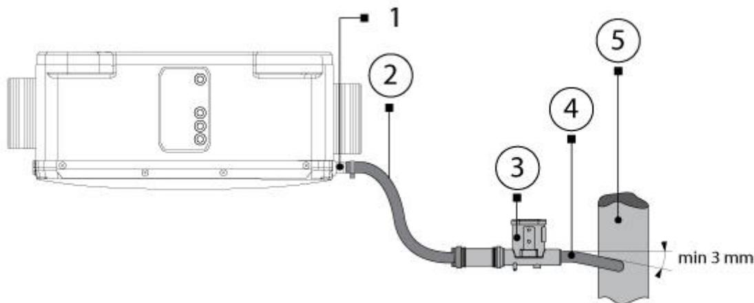
1 – tuyau d'évacuation ; 2 – tuyau de raccordement ; 3 – Piège en U ; 4 – tuyau de raccordement ; 5 – système d'égouts.
