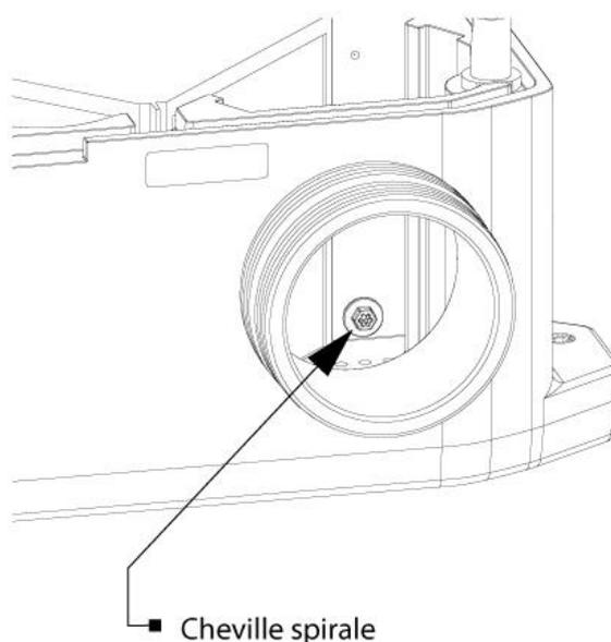
8. Vissez le cheville spirale au nouvel emplacement du capteur. Fixez-y le capteur à l'aide d'une vis autotaraudeuse. Connectez les fils du câble aux bornes du capteur dans le même ordre que celui dans lequel ils ont été connectés avant le démontage.
