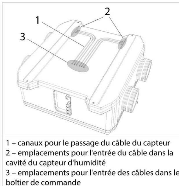
7. Retirez la vis autotaraudeuse qui fixe le capteur d'humidité. Dévissez la cheville en spirale dans laquelle la vis était vissée.
