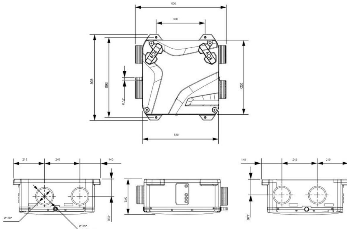
\*L'unité peut être connectée à un système de conduits d'air de 100 mm ou 125 mm.
