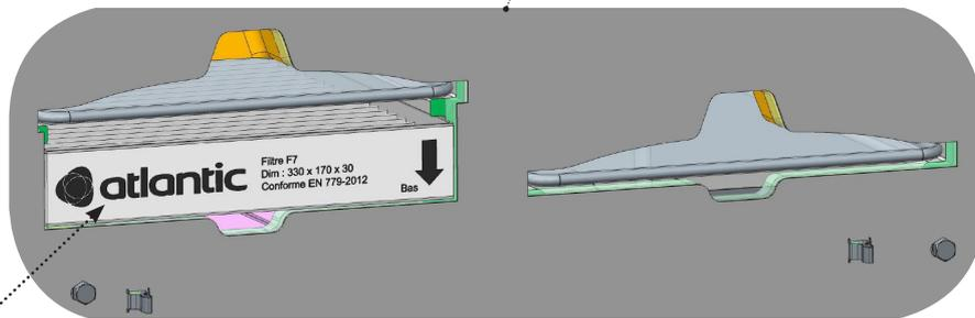
Retirer le filtre F7 d'Entrée air neuf installé d'usine et le remplacer par votre filtre à charbon actif
