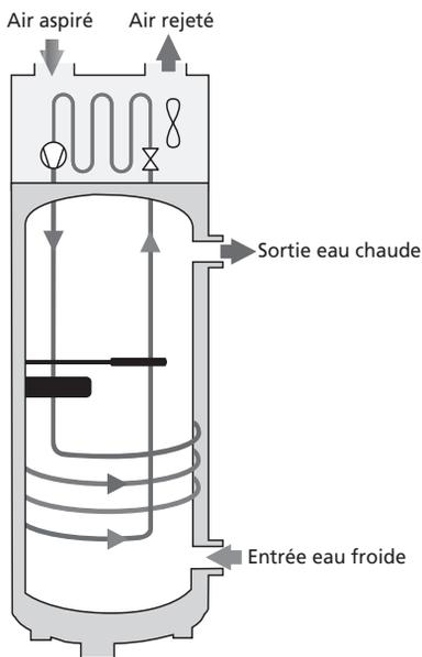
Le chauffe-eau thermodynamique utilise l'air extérieur pour la préparation de l'eau chaude sanitaire.
