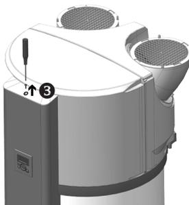
❸ Retirer la vis de verrouillage de la colonne.
