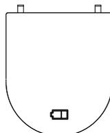
Vous devez insérer la pile (CR2430) dans la commande digitale dans les 10 minutes qui suivent l'alimentation électrique du radiateur sèche-serviettes.
