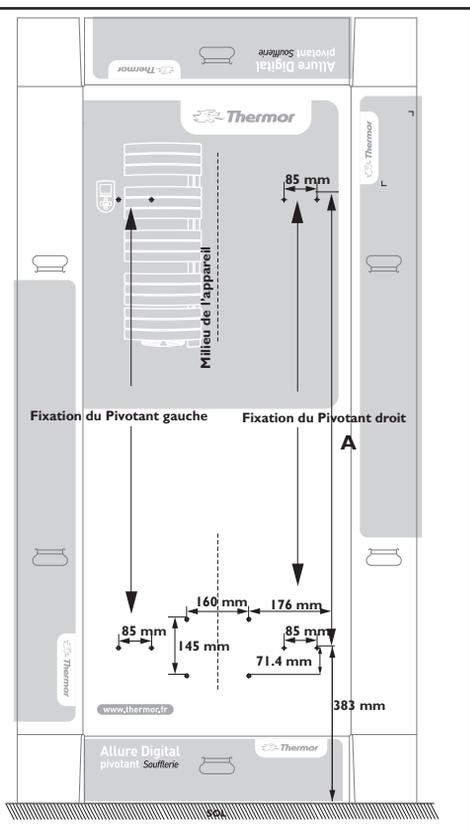
**3** Enlevez le couvercle. Utilisez des chevilles adaptées à votre type de cloison (ex : en cas de plaque de plâtre, utilisez des chevilles métalliques à expansion M5 pour le radiateur sèche-serviettes, M4 pour le ventilateur). Pré-vissez les 4 vis de fixation du radiateur sèche-serviettes (*laissez les vis dépasser de 8 mm maxi*).
