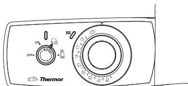
Autre exemple : La molette **D** est positionnée sur 21° C. La température affichée sur votre thermomètre est de 18° C. La valeur d'étalonnage sera donc de -3° C (3 crans).
