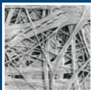
Microfibres Tyvek®, une couche fonctionnelle (µm) épaisse et visible pour une durabilité prouvée
