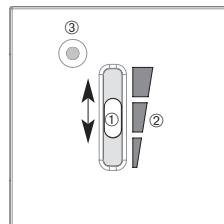
Ajustement des potentiomètres ① à ⑤
