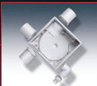
**Une flexibilité infinie:** boîtier de type ELS-GU et -GUBA pour la ventilation d'une ou de deux pièces avec possibilités de branchement sur la gauche, la droite, en partie basse ou pour raccordement direct sur une cuvette de WC. Piquage de rejet en partie haute, à gauche, droite ou à l'arrière.
