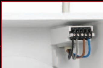
**Simplicité du connecteur électrique.** Possibilité de le sortir de son support pour un branchement aisé. L'introduction des câbles et le raccordement du connecteur s'effectuent lors du montage du boîtier. L'insertion du groupe moto-ventilateur avec sa façade s'effectue à la fin du chantier.
