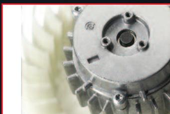
**Moteur économique à haut rendement.** Roulement à billes LongLife pour 40 000 h de fonctionnement en toutes positions. Sans entretien, dans un carter fermé en fonte d'aluminium. Faible consommation électrique: 9 W seulement en PV.
