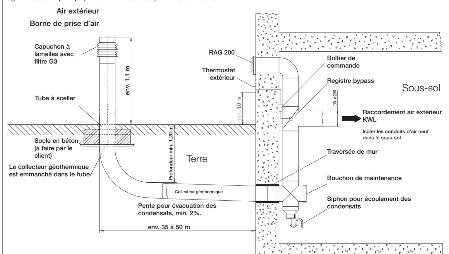
Fig.1 Schéma de principe pour une installation en pavillon sans sous sol enterré, collecteur sous le niveau des fondations - regard enterré au point bas
