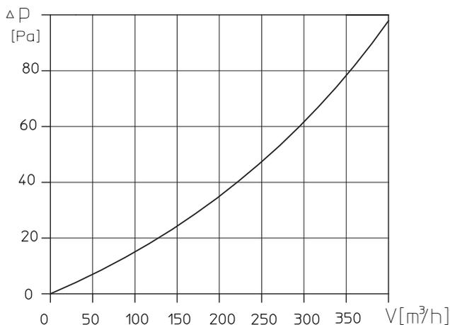
Pertes de charges du capuchon à lamelles avec filtre à air classe G3 et collecteur géothermique longueur 40 ml (filtre et collecteur propres).
