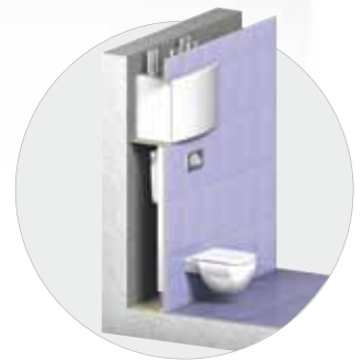
Installation en bâti-support
