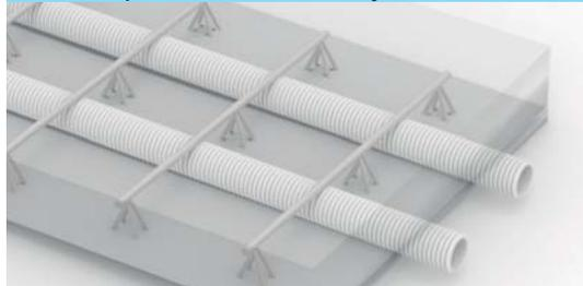
○ FlexPipe® plus Conduit plat en chape de ravoilage
