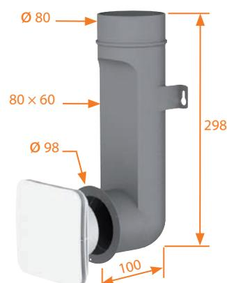
Destiné à être installé derrière une cloison, la bouche étant placée à environ 20 cm du plafond. Le manchon coudé Ø 80 est équipé de deux pattes de fixation. La bouche se monte par simple emboîtement.
