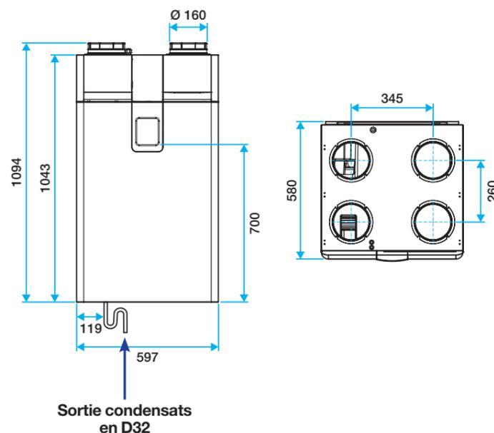
Utiliser un siphon avec 50 mm de garde d'eau minimum.
