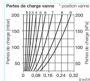
\* Nota : La vanne est livrée d'usine en position 9. En cas de débit d'eau faible, il est possible d'optimiser la régulation par un réglage de 1 à 9.
