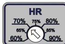
Réglage du seuil taux d'humidité du déclenchement 2<sup>ème</sup> vitesse:
