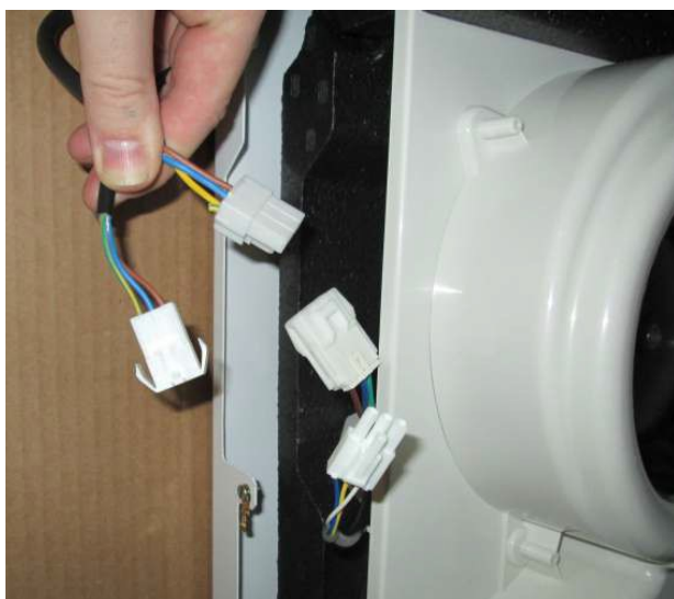
2.2 - Déconnecter les 2 câbles du moteur.
