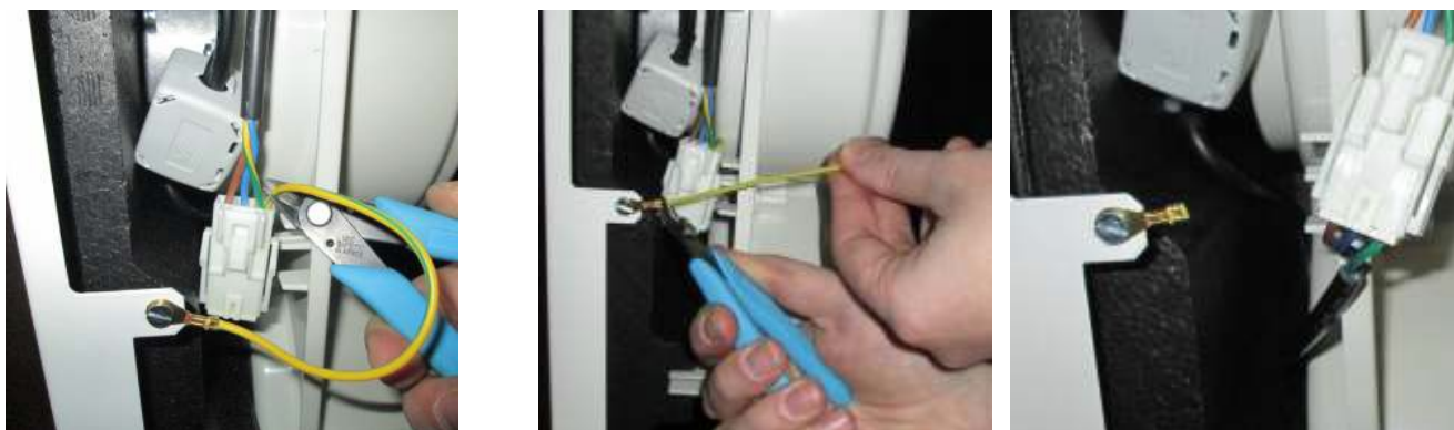
2.1 - Couper les deux extrémités du câble de terre du moteur gauche connecté au châssis.
