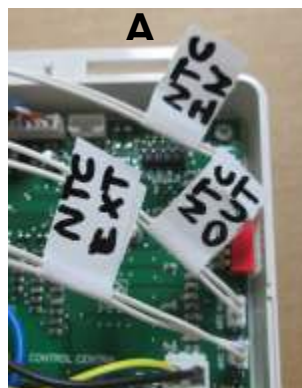
3.8 - Avant de déconnecter repérer la position des 3 sondes de température. NTC EXT (X11), NTC Out (X13), NTC In (X12) et les identifier NTC EXT / NTC OUT / NTC IN à l'aide d'étiquettes (Figure A).
