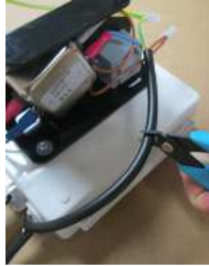
3.6 - Couper les câbles qui entourent le filtre. (Suivant votre modèle le filtre peut être différent de la photo). Couper également le câble noir.
