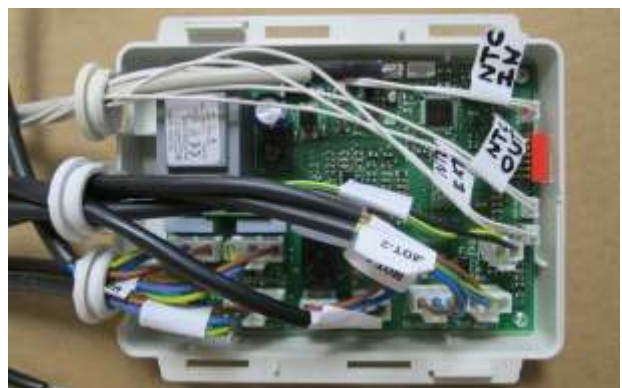
3.8 - Avant de déconnecter repérer la position des 3 sondes de température. NTC EXT (X11), NTC Out (X13), NTC In (X12) et les identifier NTC EXT / NTC OUT / NTC IN à l'aide d'étiquettes (Figure A).
