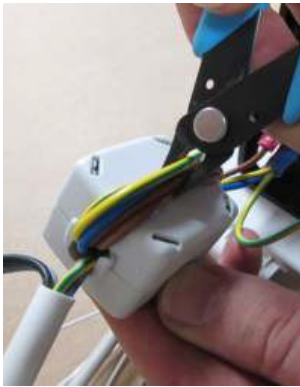
3.6 - Couper les câbles qui entourent le filtre. (Suivant votre modèle le filtre peut être différent de la photo). Couper également le câble noir.
