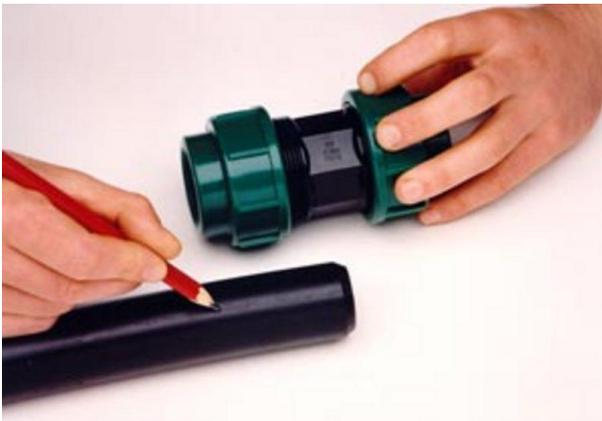
Insérez le tuyau dans le raccord PE jusqu' jusqu'au rebord, de tel sorte que le marquage fait avant soit connecté avec l'écrou vert. Afin de faciliter l'installation, l'extrémité du tuyau peut être mouillée ou être enduite d'un lubrifiant approuvé par KIWA. Serrez les écrous à la main. Utilisez suffisamment de force. En montant le tuyau sur le caisson de l'Aquacom, faites attention de bloquer le côté noir.
