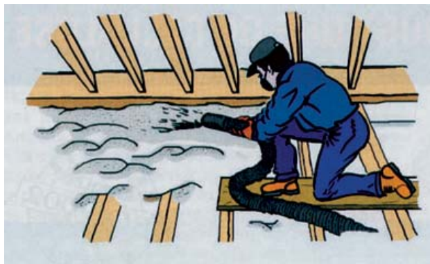
Figure F : soufflage sur planchers de combles par application pneumatique.
